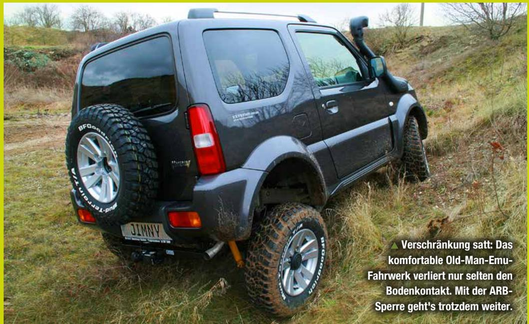
▲ Verschränkung satt: Das komfortable Old-Man-Emu-Fahrwerk verliert nur selten den Bodenkontakt. Mit der ARB-Sperre geht's trotzdem weiter.
