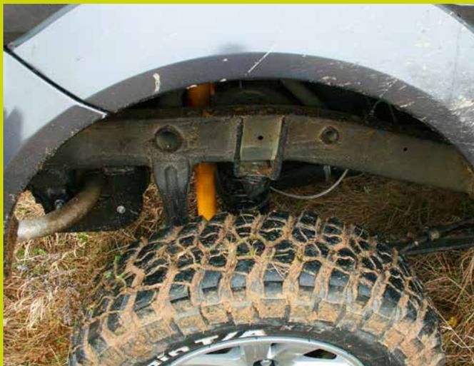
▲ Ausgefедert: Das OME-Fahrwerk verschränkt so gut, dass längere Stahlflex-Bremsleitungen vonnöten sind.
