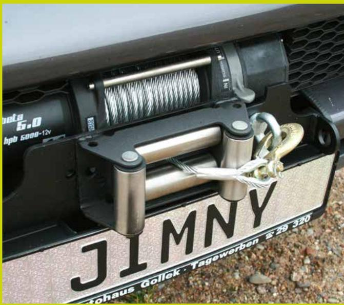
▲ Leicht zu bedienen: Die Seilwinde der Firma Horntools zieht rund 2,3 Tonnen. Die Bedienung mit der Funkfernbedienung ist unkompliziert.
