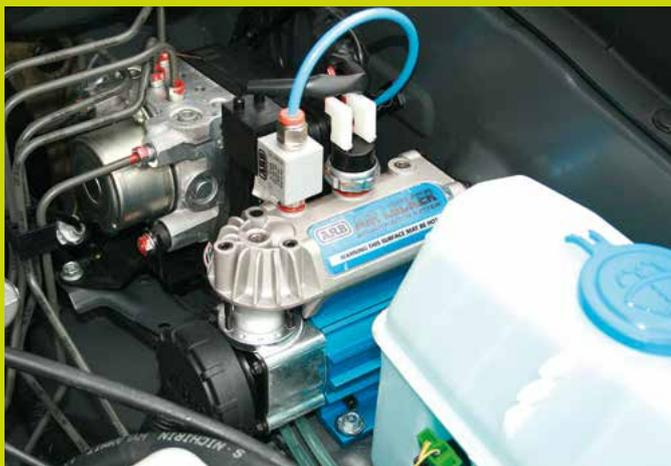
▲ Idealer Platz: Der kompakte ARB-Kompressor versorgt die Differential Sperre mit Druckluft. Er sitzt gut geschützt in der Nähe der Spritzwand.
