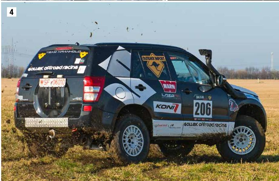
1 | Frischluft: Der große Motor sitzt nah an der Spritzwand, wo sich im Gelände die Wärme staut. Die Lufttutze verschafft der Maschine zusätzliche Kühlung.
