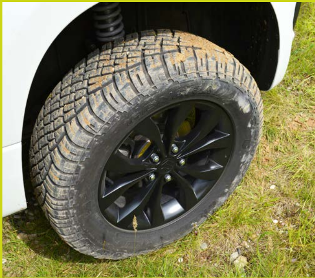
▲ Höher und breiter: Die Dimension 235/65 R17 ist etwas größer als der Serien-Reifen und passt gerade noch ins Radhaus – viel mehr geht nicht.
