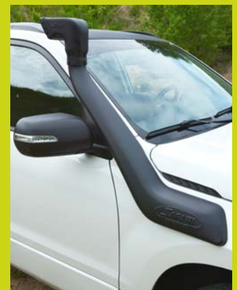
▶ Auf Tauchstation: Der Schnorchel schützt den Motor vor Wasser.
