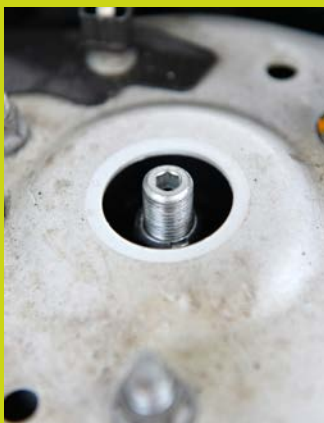
▶ Einstellbar: Über diese Schraube wird die Dämpfer-Härte justiert.
