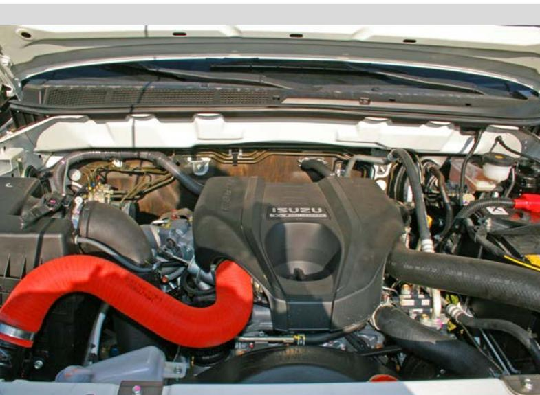
**Kraftpaket:** Der 2,5-Liter-Diesel steckt die größeren Reifen problemlos weg. Die 400 Newtonmeter liegen schon bei 1.400 Umdrehungen an.
